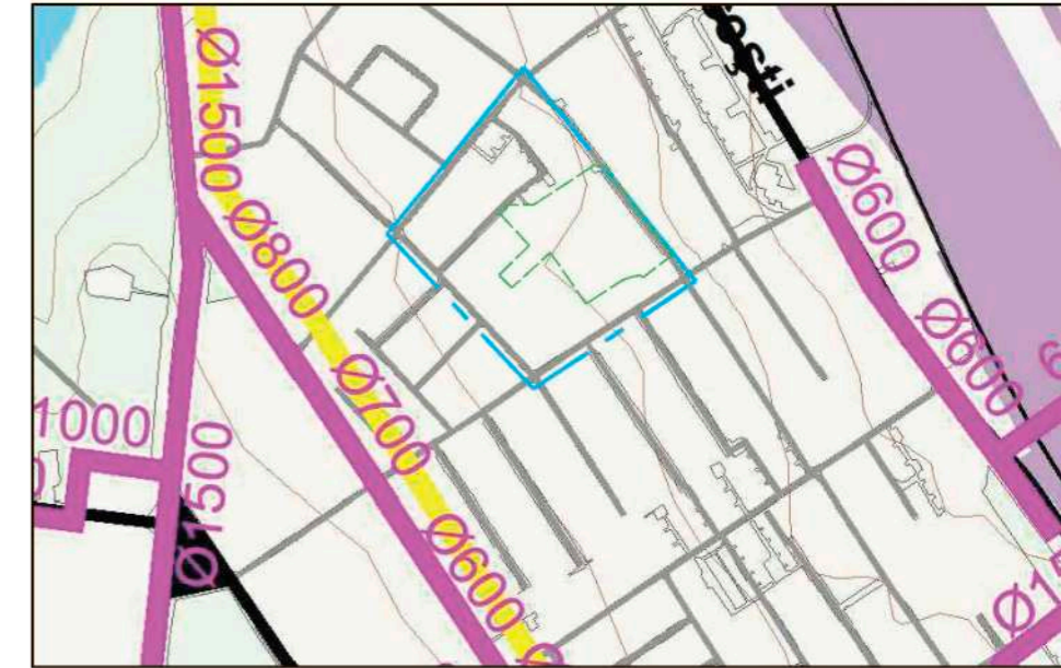
SCHEMA RETELELOR DE CANALIZARE PLUVIALA
