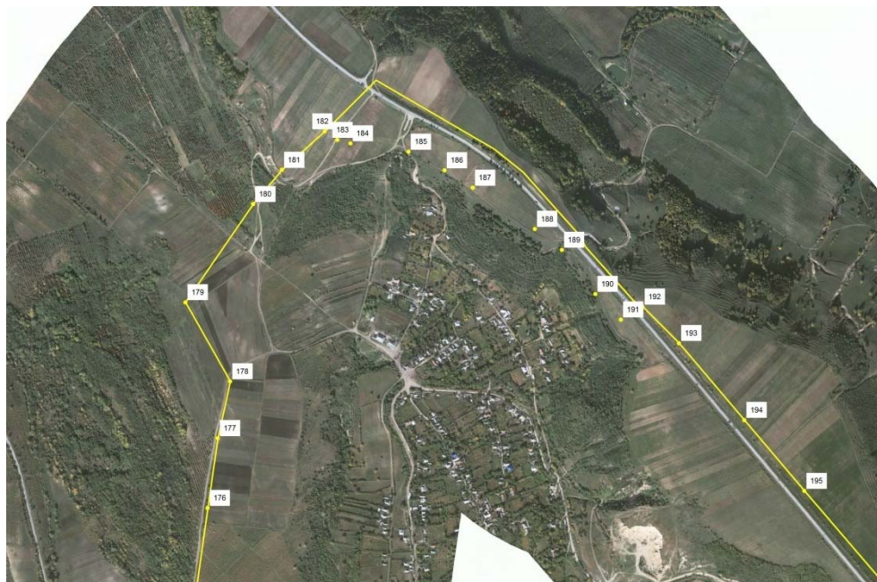
Figura 6-5: Optimizarea Opțiunii de traseu 2 între punctele 182 și 192 în scopul evitării apropierii de satul Șendreni din raionul Nisporeni (punctele galbene ne-conectate corespund liniei traseului anterior)
