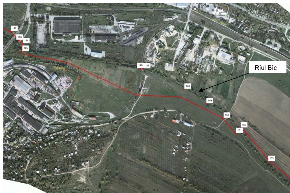
Figura 6-2: Optimizarea Opțiunii de traseu 1 între punctele 145 și 149 în scopul evitării apropierii de clădirile industriale, râul Bîc și instalația avariata de tratare a apei (punctele roșii ne-conectate corespund linei traseului anterior)
