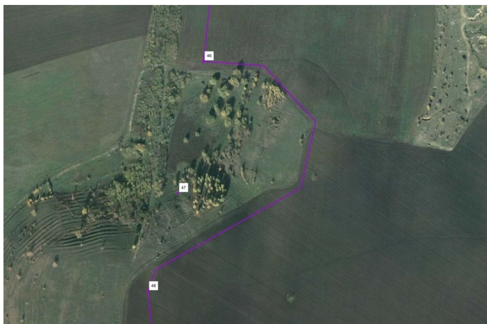
Figura 6-6: Optimizarea porțiunii comune între punctele 46 și 48, pentru a evita traversarea unei ravene (punctele violete ne-conectate corespund liniei traseului anterior)
