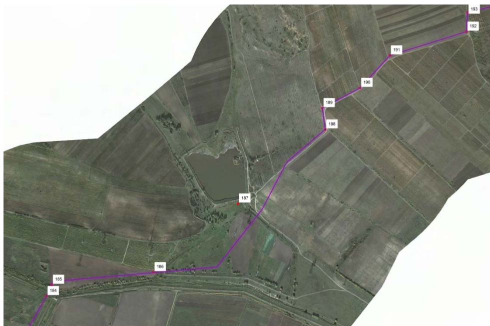
Figura 6-3: Optimizarea Opțiunii de traseu 1 între punctele 186 și 188 în scopul evitării apropierii de un lac (punctele roșii ne-conectate corespund liniei traseului anterior)
